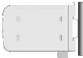
Rys. 3 Montaż na szynie TS-35 (DIN)
