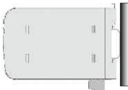
Rys. 3 Montaż na szynie TS-35 (DIN)
